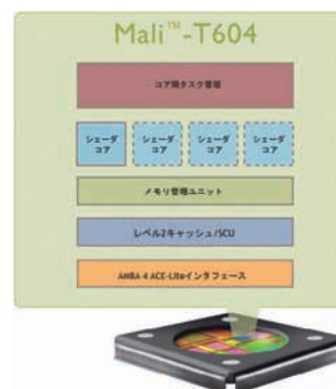
図1 Mali-T6xx GPUシリーズ第1弾のMali-T604 (シェーダ・コアは最大4個まで拡張可能)
